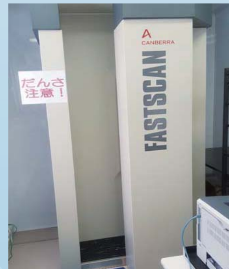
車両搭載のホールボディカウンタ（FASTSCAN） 約2分間で、体内に残留している放射性物質の量を調べることができます
